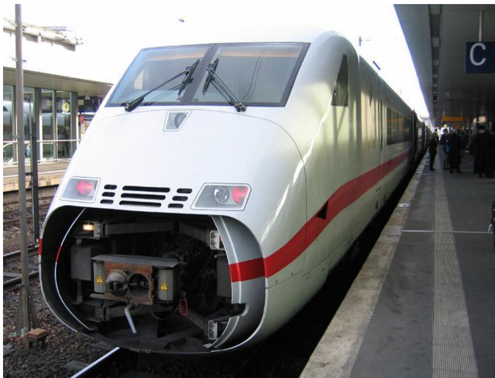
Новая автоматическая сцепка Scharfenberg
